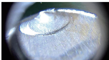
图11 陶瓷刀片剥落状态
