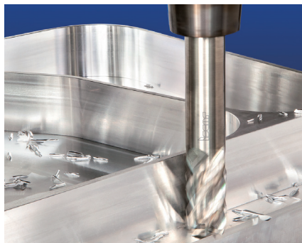
图1 整体硬质合金立铣刀铣铝加工中
