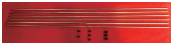
图2 冷轧大导程丝杠
