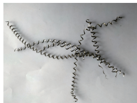
图5 粗车外圆切屑
