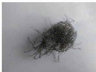
图7 精车外圆和精镗内孔切屑
