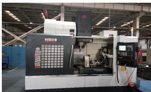
图3 NBP-1100A立式加工中心
