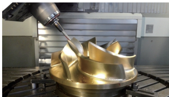
图4 多轴联动加工叶片及后盖板
