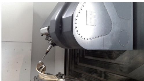
图2 多轴加工中心精铣分瓣式叶片
