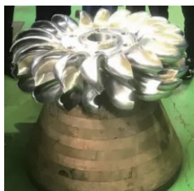
图10 增材制造冲击式水轮机真机转轮
