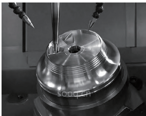
图5 全闭式叶轮的加工成形
