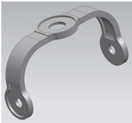
图14 线切割去除工件两侧工艺料头
