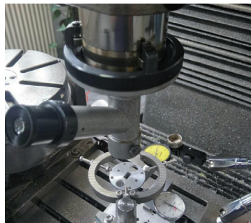
图4 使用专用显微镜对内腔进行精确找正
