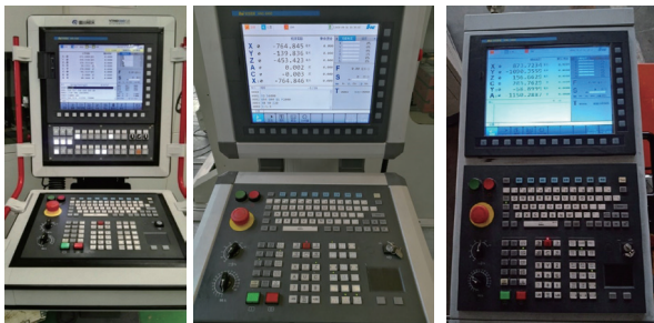
a) 七轴五坐标联动车铣复合控制 b) 六轴双模式五坐标联动镗铣控制 c) 五轴五坐标联动控制
