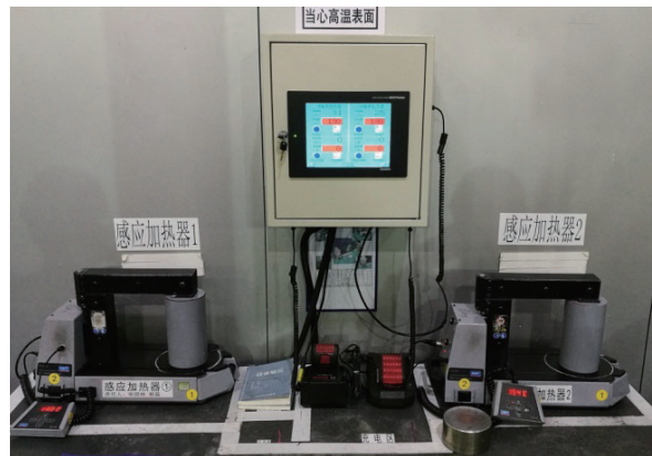
图2 研制后的轴承加热器超温控制情况
