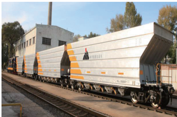
图2 25t轴重环保型煤炭运输车
