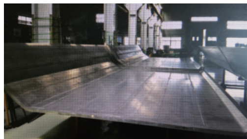
图4 160km/h快速棚车全侧开门铝合金侧门搅拌摩擦焊作业
