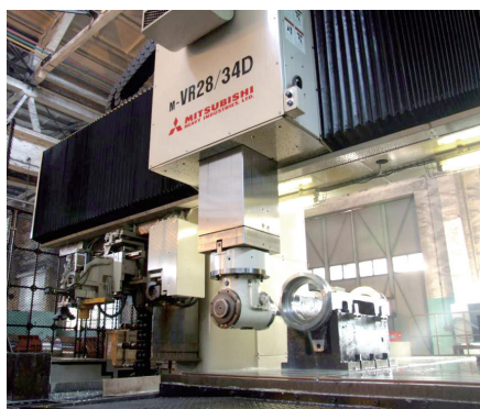
图2 龙门式五面体加工中心加工轴箱体
