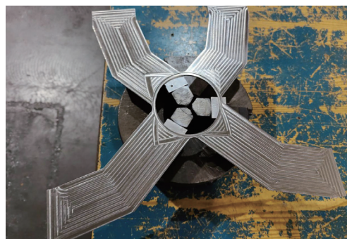
图6 自定心卡盘改装镗孔的专用夹具
