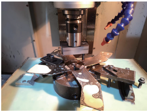
图9 镗刀扩大器试加工效果
