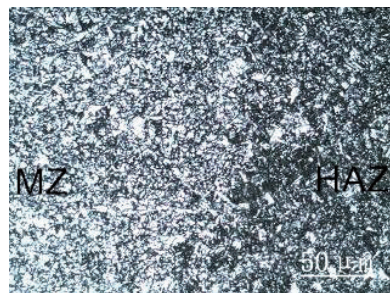
图5 焊缝区及热影响区金相组织
