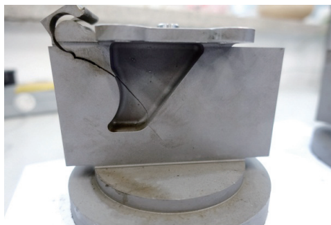
图1 线切割时安装座开裂处
