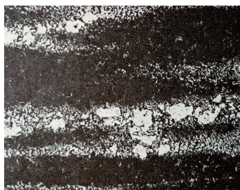
图2 CrMn钢碳化物液析 (500 \times )
