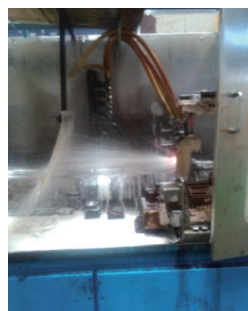
图1 感应加热淬火
