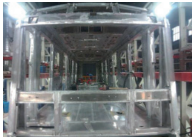
a) 首个应用FSW技术的铝合金车体
