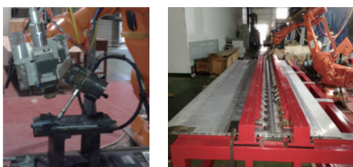
a) 激光-MIG电弧复合焊接系统 b) 空调底板激光复合焊
