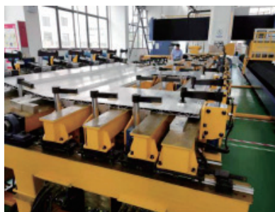
b) 侧墙FSW自动化工装
