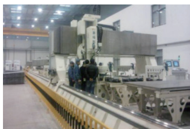
b) 首条铝合金车体部件FSW生产线
