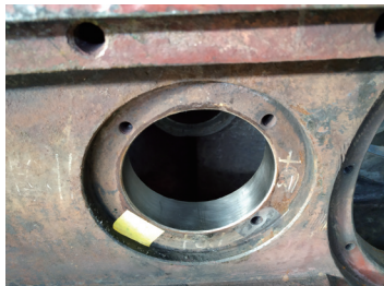
图2 电刷镀修复惰轮轴孔实物
