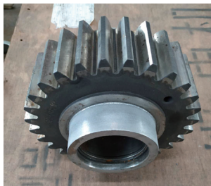
图1 激光熔覆修复齿轮效果展示
