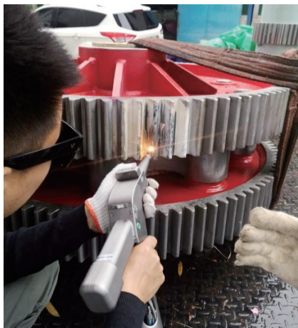
图7 齿面激光焊
