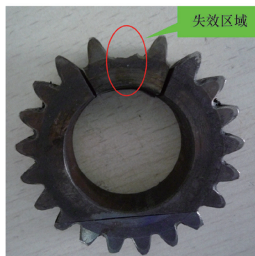
图1 行星齿轮宏观形貌
