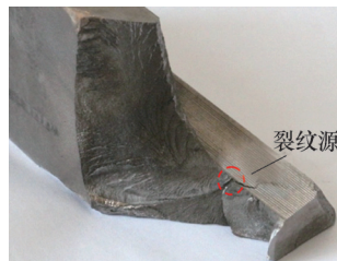
图3 齿轮裂纹源位置
