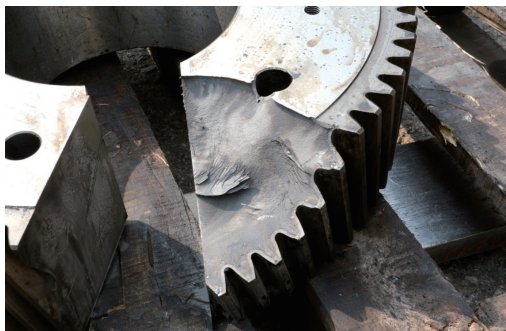
图2 齿轮断口宏观形貌
