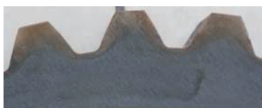
图3 方案一花键淬火后切片宏观形貌
