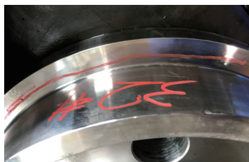
图4 外圆台阶根部圆角处裂纹
