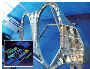
图8 北航LMD打印的机钛合金主承力构件加强框 [35]
