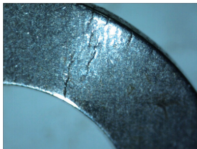
图4 完好垫圈裂纹形貌 (45×)
