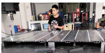
a) 底板型材搅拌摩擦焊拼焊
