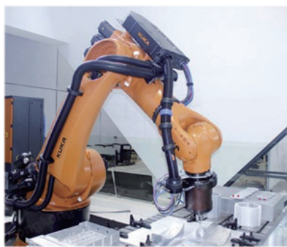
图15 机器人搅拌摩擦焊设备
