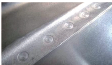
b) 回填式搅拌摩擦点焊焊点
