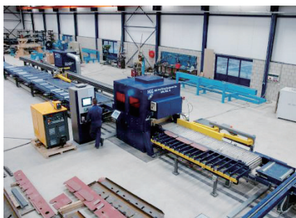
图1 典型船用型材切割生产线
