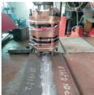
图11 外加纵向磁场辅助K-TIG焊接试验系统和装置 [20]
