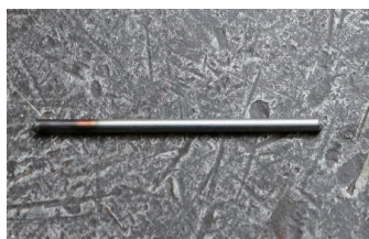
图2 钯银金镍管宏观形貌
