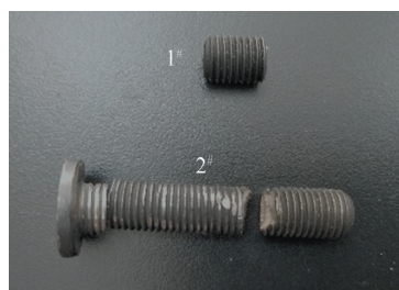
图1 连杆断裂螺栓
