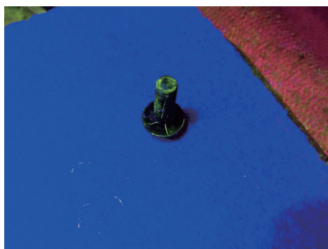
图7 经磁粉检测的淬火开裂
