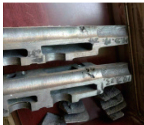
图4 挺杆孔部位缺陷形貌
