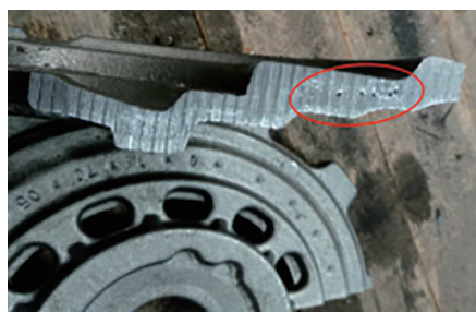
图3 原工艺铸件切割缩松缺陷
