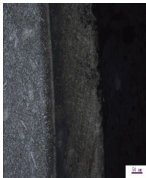
图4 1Cr11Ni2W2MoV钢2 # 试样渗氮金相组织
