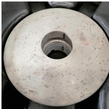
图7 回火后表面残留油斑
