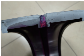
图3 外圈裂纹断口形貌
