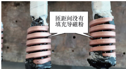
图10 导磁粉灌装没有填充饱满
