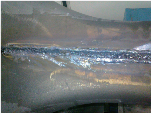
图4 焊缝气孔特点
