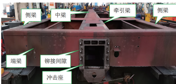
图1 铁路货车NX70底架实物
