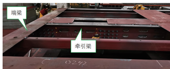
图2 铁路货车NX70牵引梁与端梁组成实物
