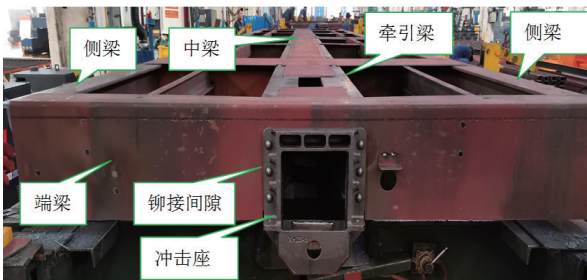
图1 铁路货车NX70底架实物
