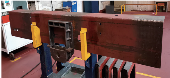
图6 端梁与冲击座铆接实物
