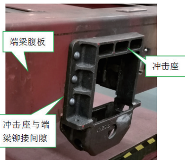
图5 冲击座与端梁铆接后实物
