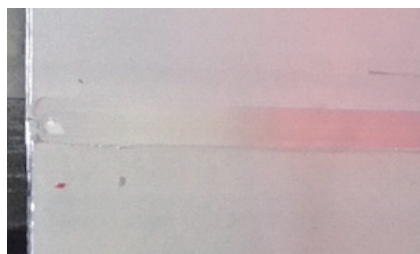
b) SSFSW焊缝（未处理）
