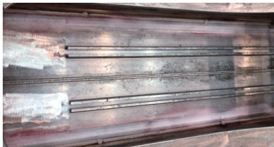
图10 T-3车枕梁垫板的PT检验数据库的采集
