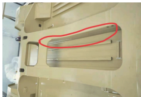
图1 T-1车长约2103mm的裂纹
