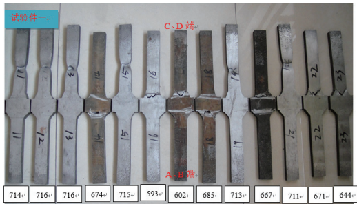
图5 试样1断裂位置及破断力值 (kN)
