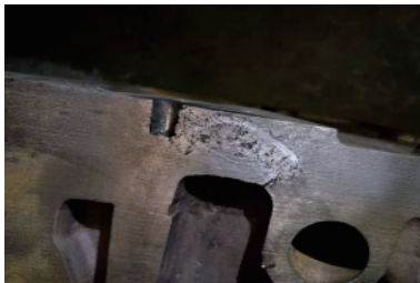
图1 汽缸盖疏松缺陷
