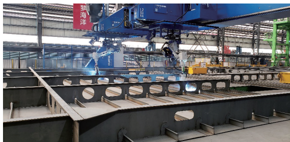
图1 平面分段中组立焊接机器人
