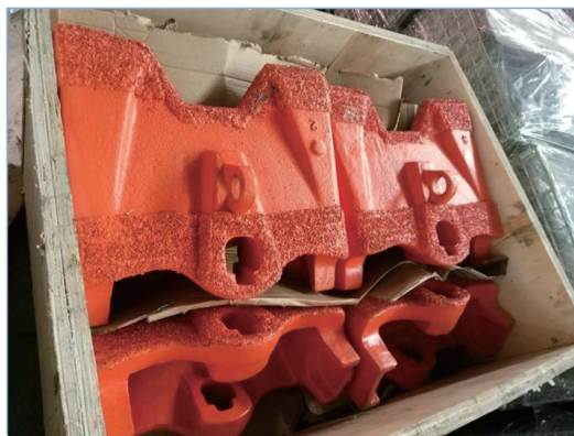
图7 碳化钨给料器复合技术制备的产品形貌
