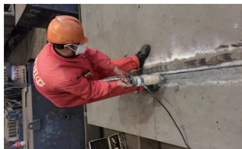
图6 超声波振动锤击法消应力现场应用
