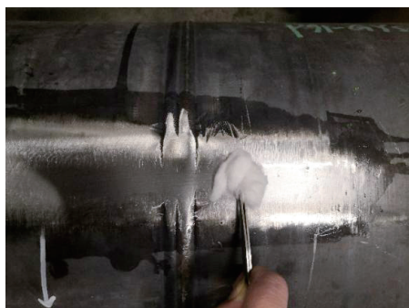
图3 打磨并酒精清洗待测表面
