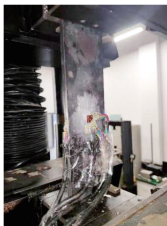
图5 钻孔后试板拉伸
