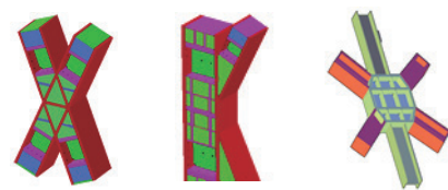
a) X节点 b) Y节点 c) 米字形节点梁
