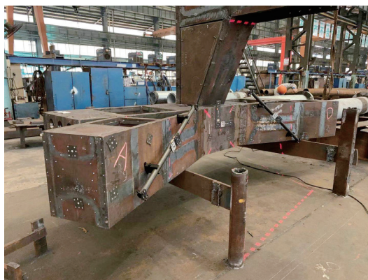
图8 使用三维扫描设备测量牛腿端部尺寸
