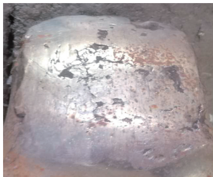
图2 齿面磨损与剥落宏观形貌
