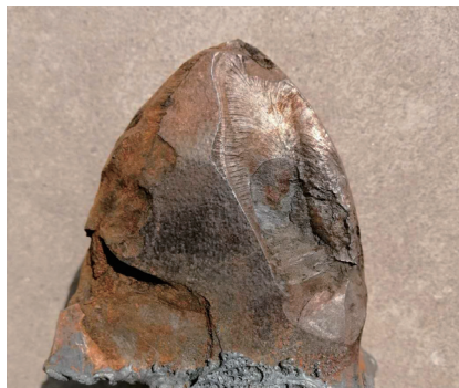
图1 齿轮端面及棱剥落宏观形貌
